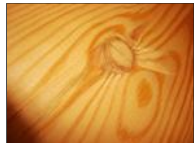
Oksalla paikattu oksanreikä
