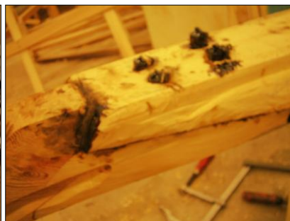
Vannas ja kölipuu liitettynä vinoliitoksella ja tapeilla
